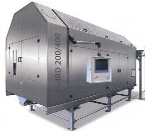
Das FoodSafety-IRD Verfahren ist ein thermisches Verfahren, das die Wärme dem Rohstoff gezielt durch Infrarotlicht zuführt.
